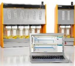
**FIBREtherm** je namenjen za analizu sadržaja celuloze i nesvarljivih vlakana ali i ADF i NDF vlakna. Jedinstven je po kapacitetu od 12 mesta koji može i ne mora biti u potpunosti iskorišćen. Jedinstvena i patentirana tehnologija FibreBag vrećica nudi vrhunske rezultate uz prijemčivu i jednostavnu upotrebu.
