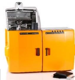
Određivanje proteina metodom po Dumasu. Ovim načinom analize ne koriste se agresivne hemikalije, trajanje analize meri se u minutima, a količina uzorka je manja od grama. Visokotehnološka rešenja čine upotrebu jednostavnom, a rezultate vrlo preciznim i pouzdanim uz izuzetan konfor i bezbednost korisnika.
