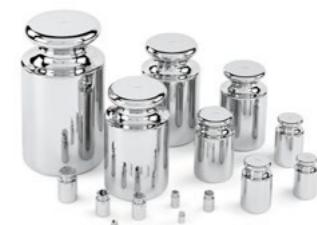
**Laboratorijska oprema za etaloniranje merila mase**
