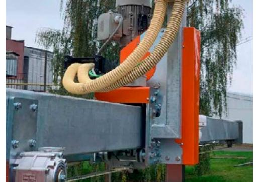
Četvrtasti dupli zidovi uzorkivača sa bočnim nosačem na teleskopskoj ruci za lakše servisiranje
