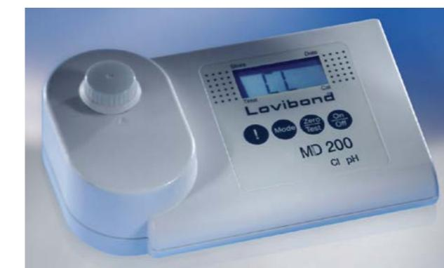
**Fotometri LOVIBOND**, omogućavaju jednostavan i pouzdan rad na terenu i u laboratoriji.
