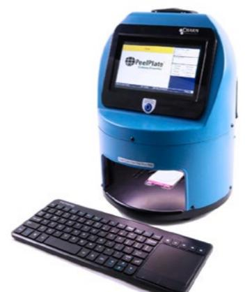
Uštedite vreme na brojanju kolonija Peel plate testova sa novim brojačem kolonija- Peel plate colony counter II.
